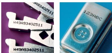
Quando sono sottoposti a temperature intorno a 175° C (350° F) per 30 minuti, i codici stampati con gli inchiostri di Videojet resistenti a solventi/agenti chimici subiscono uno speciale processo (curing) in ragione del quale diventano resistenti al trasferimento e alla rimozione provocati dal vapore, alle abrasioni e a molti solventi.
